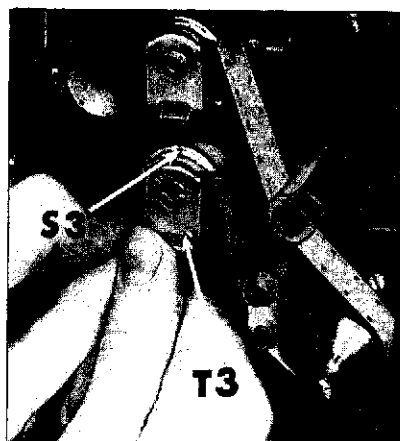
Figure 14 S3 Sprocket T3 Sprocket tab
